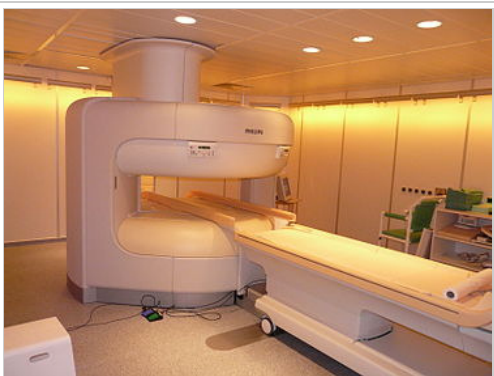
واحد تسلا جهاز تصور رنين مغناطيسي مفتوح.
